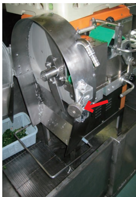
▲回転刃の蓋を開けると機械が停止するリミットスイッチ（矢印の部分）が取り付けられた例
