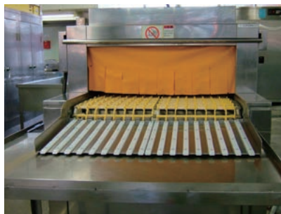
▲左右どちらからでも操作できるレバー式非常停止装置の例
