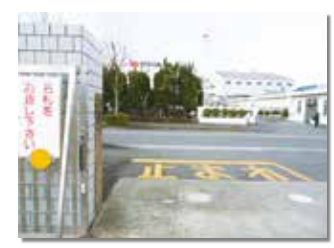
■一時停止ライン及び「止まれ」表示を実施し接触事故を防止
